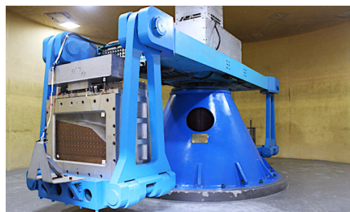
图 1 CKY-200 型土工离心机 Fig.1 CKY-200 geotechnical centrifuge
